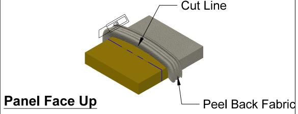
CUT PANEL, FACE UP, WITH A STRAIGHT EDGE OR RAZOR KNIFE (CARE SHOULD BE TAKE TO AVOID CUTTING FABRIC)
